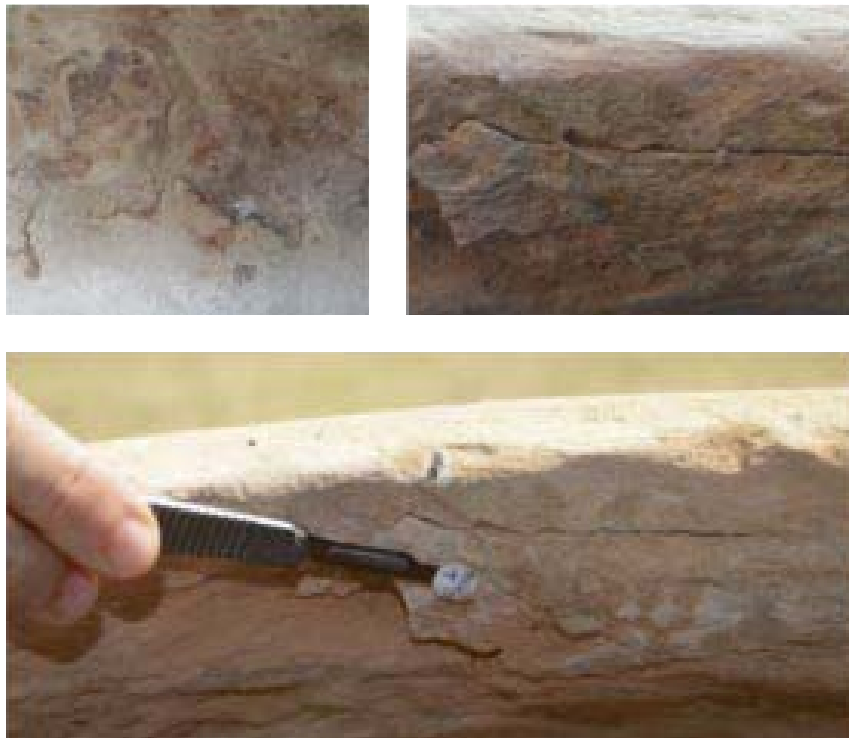
Fig. 8. Ampie zone di distacco e scagliatura e area di campionamento all'interno dell'inv. 19075.
